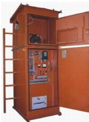
**ЯКУ-1** ячейка карьерная наружной установки отдельно стоящая, предназначена для работы в сетях трехфазного тока напряжением 6-10 кВ частотой 50 Гц и используется для подключения питания и защиты электрооборудования мощных карьерных потребителей.
