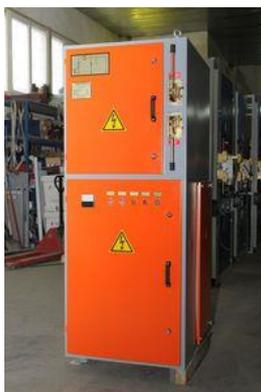
**2КВЭ-6** - изготавливаем все модификации данных высоковольтных ячеек, предназначенных для установки на поворотной платформе в закрытом неотапливаемом кузове карьерных экскаваторов и служат для приема и распределения электроэнергии трехфазного переменного тока напряжением 6 кВ частотой 50 и 60 Гц в карьерных распределительных сетях с изолированной нейтралью, а также для защиты электропотребителей при перегрузках и коротких замыканиях, для оперативного включения электрических цепей управления.
