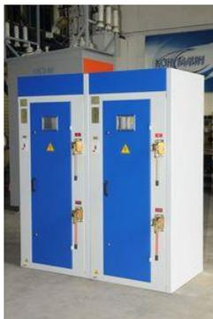
**КСО-399** камера сборная одностороннего обслуживания, предназначена для работы в электрических установках трехфазного переменного тока частоты 50 и 60 Гц напряжением 6 и 10 кВ для системы с изолированной или заземленной через дугогасящий реактор нейтралью.
