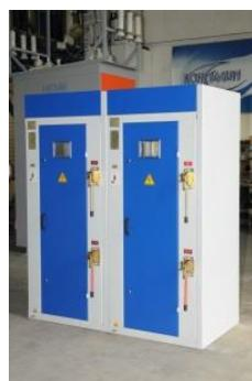
**KCO-366** камера сборная одностороннего обслуживания, предназначена для работы в электрических установках трехфазного переменного тока частоты 50 и 60 Гц напряжением 6 и 10 кВ для системы с изолированной или заземленной через дугогасящий реактор нейтралью.
