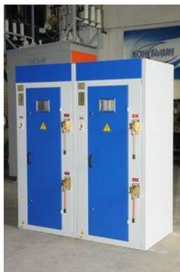
**КСО-301** камера сборная одностороннего обслуживания, предназначена для работы в электрических установках трехфазного переменного тока частоты 50 и 60 Гц напряжением 6 и 10 кВ для системы с изолированной или заземленной через дугогасящий реактор нейтралью.
