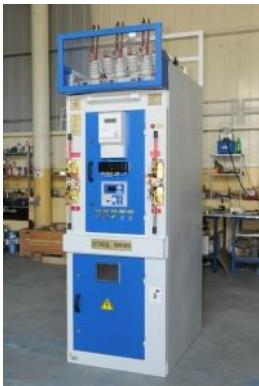
**KCO-292** камера сборная одностороннего обслуживания, предназначена для работы в электрических установках трехфазного переменного тока частоты 50 и 60 Гц напряжением 6 и 10 кВ для системы с изолированной или заземленной через дугогасящий реактор нейтралью.
