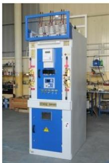
**КСО-286** камера сборная одностороннего обслуживания, предназначена для работы в электрических установках трехфазного переменного тока частоты 50 и 60 Гц напряжением 6 и 10 кВ для системы с изолированной или заземленной через дугогасящий реактор нейтралью.
