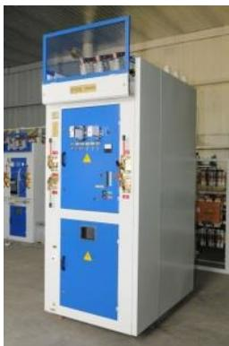
**КСО-272** камера сборная одностороннего обслуживания, предназначена для работы в электрических установках трехфазного переменного тока частоты 50 и 60 Гц напряжением 6 и 10 кВ для системы с изолированной или заземленной через дугогасящий реактор нейтралью.
