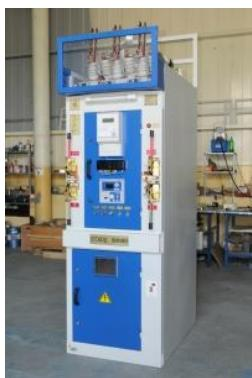
**KCO-205** камера сборная одностороннего обслуживания, предназначена для работы в электрических установках трехфазного переменного тока частоты 50 и 60 Гц напряжением 6 и 10 кВ для системы с изолированной или заземленной через дугогасящий реактор нейтралью.
