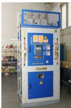
**КСО-203** камера сборная одностороннего обслуживания, предназначена для работы в электрических установках трехфазного переменного тока частоты 50 и 60 Гц напряжением 6 и 10 кВ для системы с изолированной или заземленной через дугогасящий реактор нейтралью.
