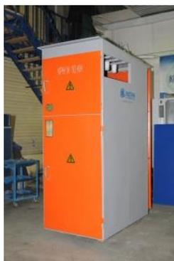
**Ячейка КРН-IV-10** предназначена для приема и распределения электрической энергии трехфазного переменного тока частотой 50 Гц напряжением 6 и 10 кВ и используется в распределительных устройствах собственных нужд электростанций, электрических подстанций энергосистем и промышленных предприятий, а также на объектах энергоснабжения ответственных потребителей сельского хозяйства.
