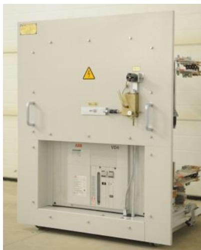
Выкатной элемент KM-1Ф - техническое описание выкатного элемента с вакуумным выключателем VD4 ABB предназначено для изучения принципа действия и правил его эксплуатации.
