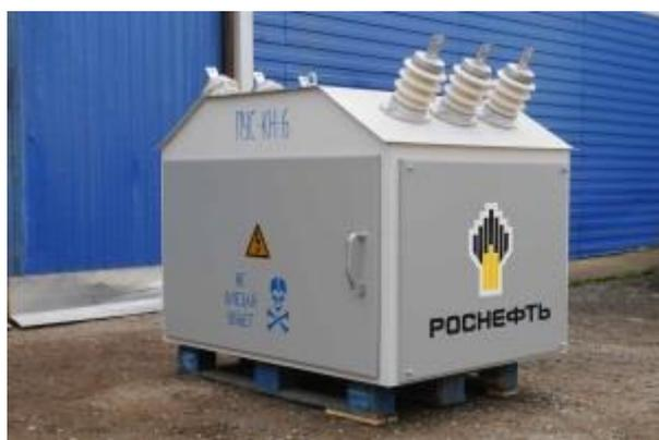
Пункт учета и секционирования ПУС - предназначен для повышения надежности ЛЭП 6-10 кВ за счет автоматического секционирования воздушных линий с двухсторонним и односторонним питанием, автоматического ввода резерва, сетевого резервирования, а также за счет разделения линий электропередач на отдельные участки для обеспечения бесперебойной работы подстанций, не входящих в участок с поврежденной подстанцией.
