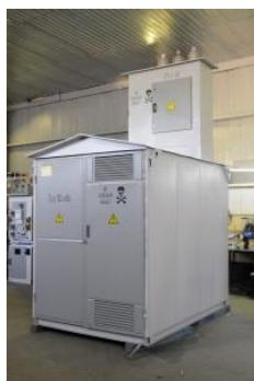
**КТП-630** комплектная трансформаторная подстанция наружной установки трехфазного переменного тока частотой 50 Гц, представляет собой электротехническое устройство, предназначенное для приема, преобразования (по уровню напряжения при помощи силовых трансформаторов), передачи и распределения электрической энергии.
