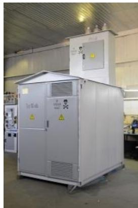
**КТП-40** комплектная трансформаторная подстанция наружной установки трехфазного переменного тока частотой 50 Гц, представляет собой электротехническое устройство, предназначенное для приема, преобразования (по уровню напряжения при помощи силовых трансформаторов), передачи и распределения электрической энергии.
