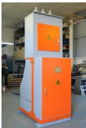
**КТП-250 мачтовая** комплектная трансформаторная подстанция предназначена для приема электрической энергии трехфазного переменного тока частотой 50 Гц, напряжением 6 или 10 кВ, преобразования в электроэнергию напряжением 0,4 кВ и снабжению ею потребителей.
